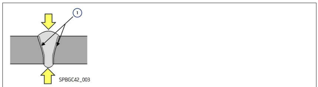
Abb. 4-10 Vorbereitungs-Schweißnaht - Abgeschrägte Kanten
