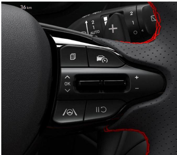
Das N Lederlenkrad verfügt über Schaltwippen, die Ihnen schnelle Schaltvorgänge ermöglichen (nur bei DCT).
