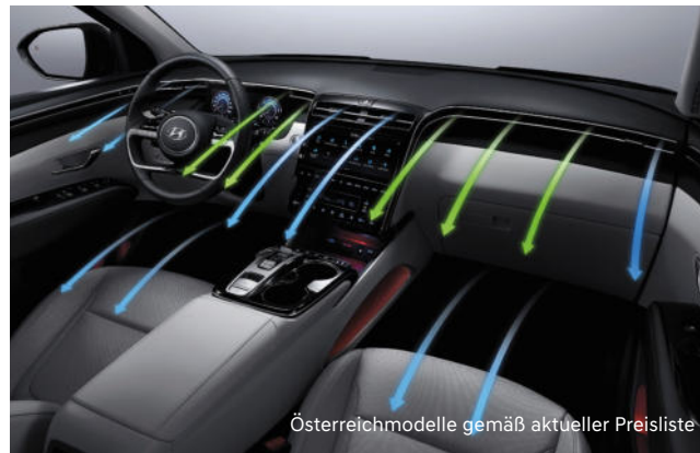
Multi-Air-Modus mit indirekten Lufteinlässen
